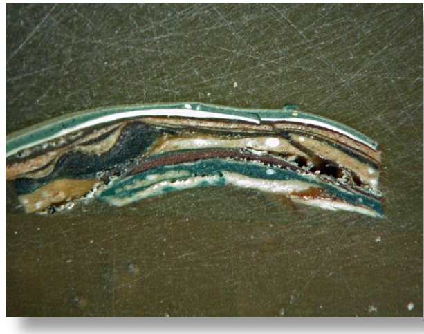
Kleuronderzoek op trapbaluster, rechts het microscoop-preparaat: er blijken ruim 12 lagen te zijn; een kleurtrapje brengt niet altijd alles aan het licht!
